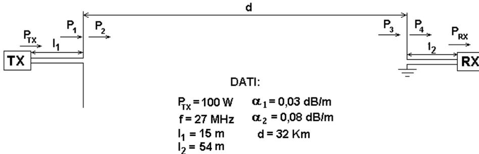
Si determinino inoltre le lunghezze della antenna trasmittente, di tipo hertziano, e della ricevente, di tipo marconiano.
