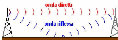
In taluni casi è invece indispensabile, come ad esempio, nel funzionamento degli altimetri radaristici degli aerei, o dei missili che devono volare a precise quote per non farsi intercettare, o nel rilievo della forma della superficie terrestre dai satelliti artificiali, o, per quelle antenne che utilizzano l'effetto immagine della superficie terrestre per aumentare il proprio guadagno.
